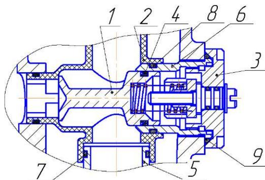
**Рис. 3 Конструкция перепускного клапана начиная с октября 2007 г. (см. каталог составных частей ФГ 379.05.00.00)**
