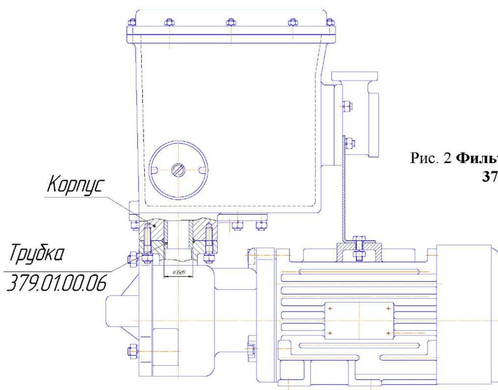
**Рис. 2** Фильтр-газоотделитель
