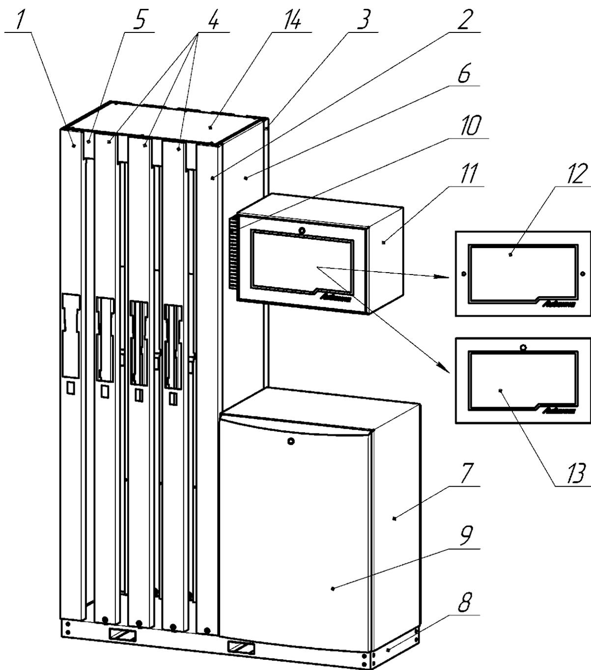
Каркасы производятся с 2009г., материал – оцинкованная сталь. Отличия: цельные основание, боковая стенка, угольник, скругленные панели, наружные крепежные отверстия на основании.
